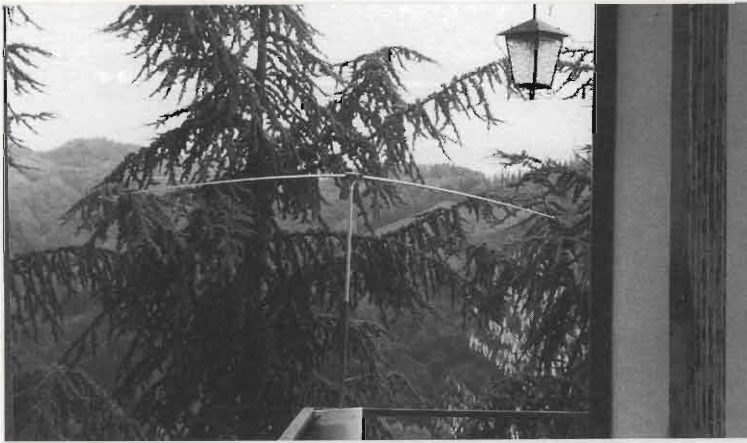
Foto 3 - "Magic antenna" pronta per le trasmissioni sui 50 MHz. Come si può vedere, essa è fissata su di un manico di scopa ed è stata collocata in una posizione nelle cui vicinanze sono presenti degli ostacoli (cioè alcuni alti alberi) per simulare le condizioni operative tipiche delle vacanze in montagna.
