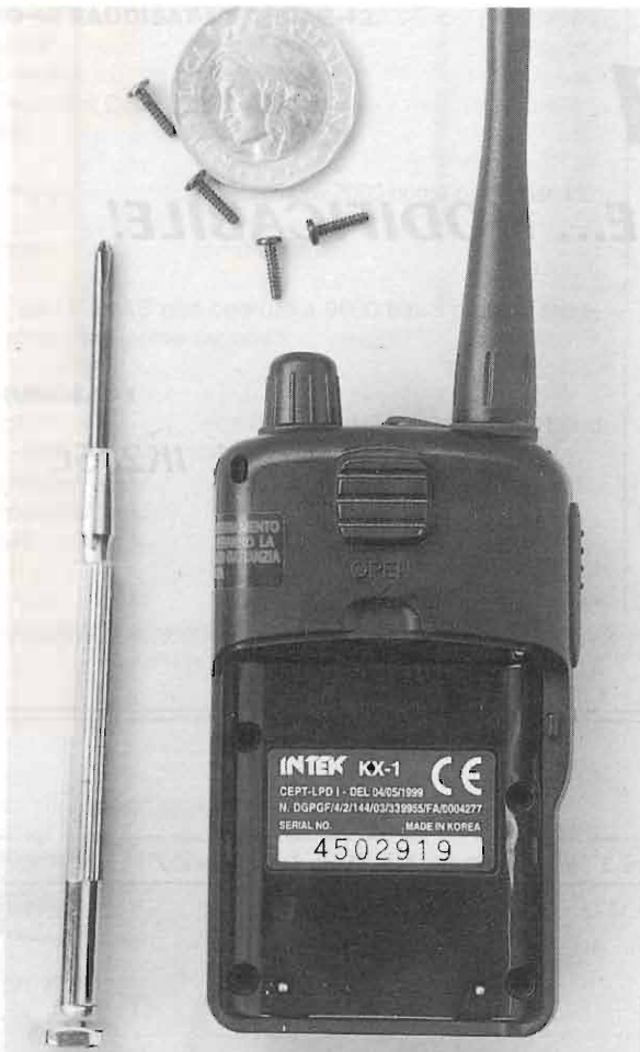
Foto 2 - Vista dell'apparato nella parte posteriore privato del pacco batterie, la moneta mostra le dimensioni estremamente ridotte di questo LPD. Da notare anche l'etichetta di omologazione nel nuovo formato in vigore da quest'anno.
