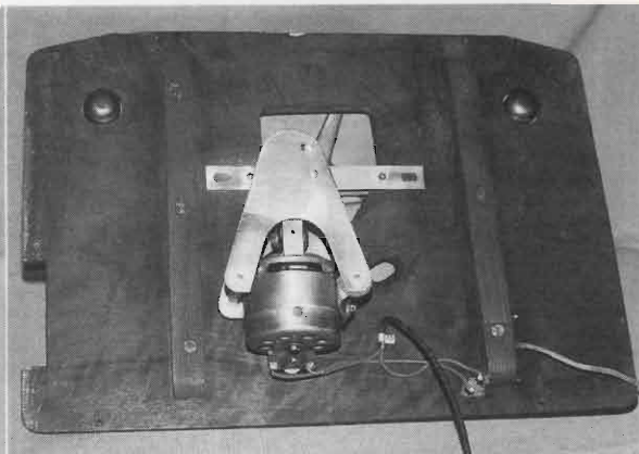
Foto 4 - Il motorino di trazione.
